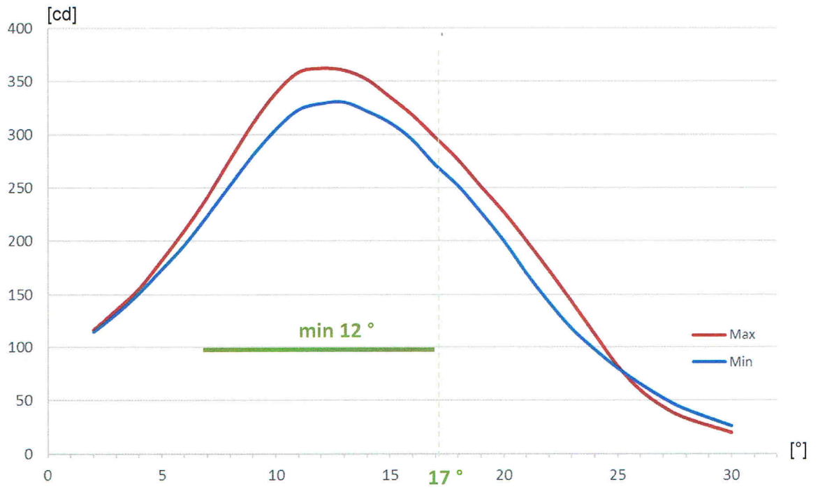
Rys. 4 Rozwarcie pionowe wiązki światła przy napięciu zasilania 28V Fig. 4 Vertical beam spread at supply voltage 28V
