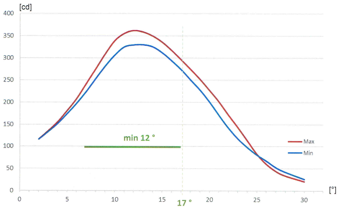
Rys. 2 Wykres światłości przy napięciu zasilania 28V Fig. 2 Luminous intensity at supply voltage 28V
